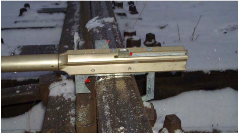
Figur K10.1 Redskap placeras vinkelrätt mot tunga/stödräl.
